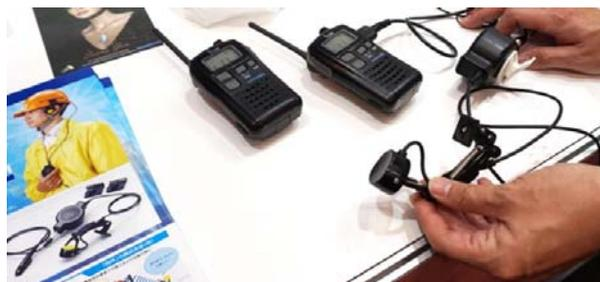
骨伝導イヤホンとマイクのトランシーバー。耳栓をしたまま相手の声を聴き、かつ、こちらの声も骨伝導で相手に伝えます。騒音環境でもクリアに聞こえるよう設計されていて、なかなかクリアな音質でした!
